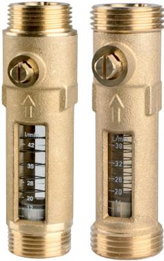
Для гидравлического уравнивания и контроля расхода жидкости в системах отопления/охлаждения, кондиционерах и устройствах, работающих на солнечной энергии, а также в геотермии. DFM позволяет осуществлять настройку установки или модуля установки без использования диаграмм, таблиц или измерительных приборов. Предназначен для измерения расхода горячей и холодной воды, а также для водных смесей с типичными антикоррозионными и противоморозными добавками.
