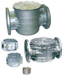
Фильтры для газа предназначены для очистки сухих газов (природный газ, воздух, сжиженный газ, окись углерода и др.) от механических примесей со степенью очистки  $\leq 50$  мкм при давлении до 6 бар (6 кгс/см<sup>2</sup>) и температуре окружающей среды -40+70 °С.
