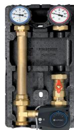
**Основной комплект:** шаровой кран с гравитационным тормозом, термометр (синий); шаровой кран, термометр (красный); шаровой кран на линии прямого потока; изоляция; настенный крепеж и комплект для подключения.
