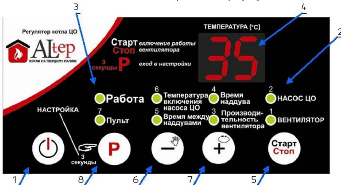
Рисунок 3 – Зовнішній вигляд передньої панелі контролера
