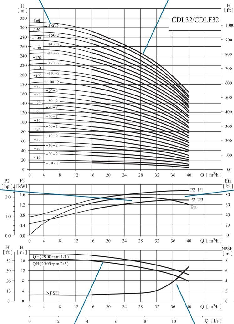
График характеристики мощности показывает мощность каждой ступени электронасоса. Представлены, графики характеристики мощности для рабочих колес стандартного (1/1) и уменьшенного (2/3) диаметра
