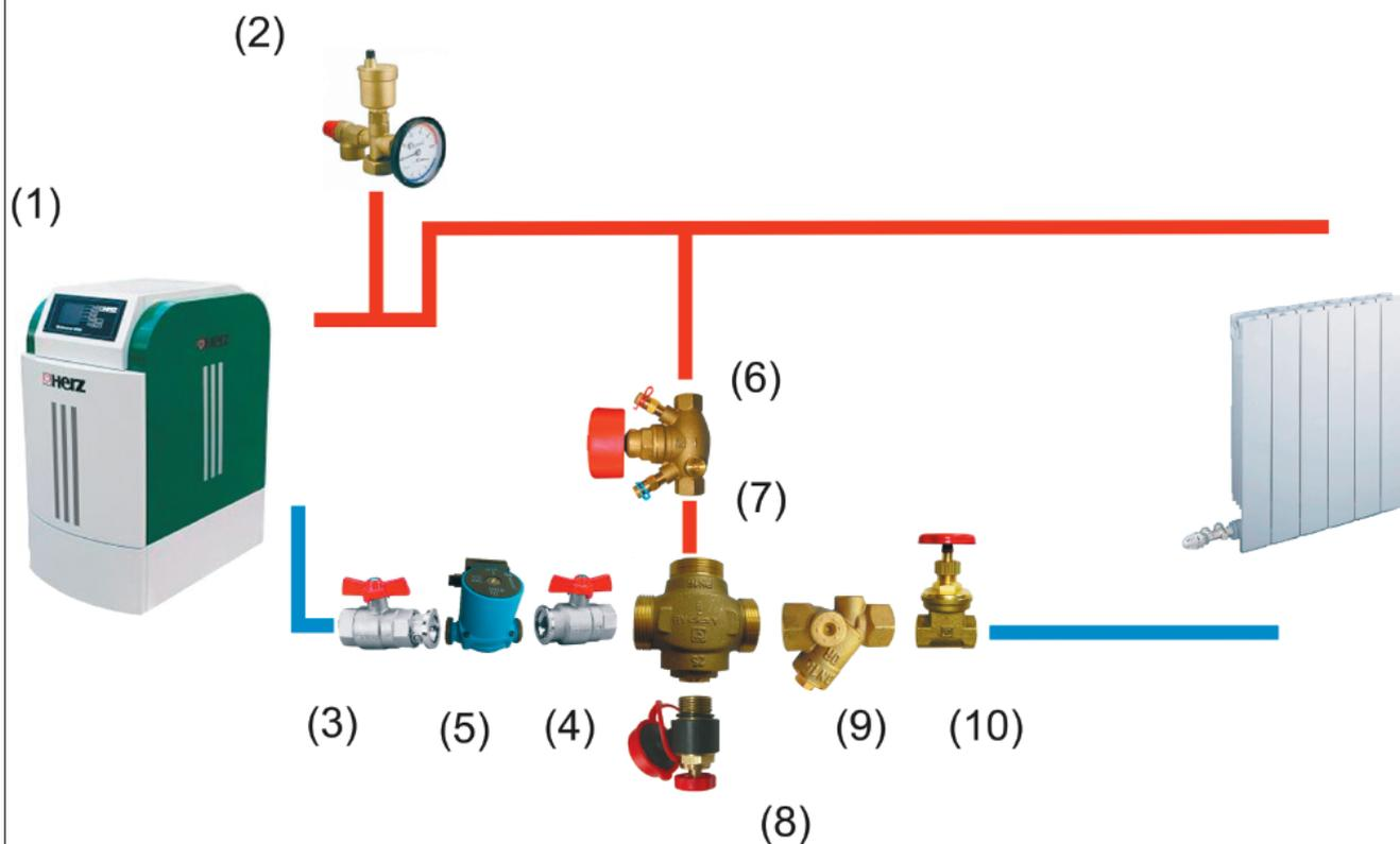
Балансировочный вентиль (6) должен быть настроен на 10% от общего расхода теплоносителя
