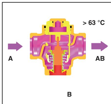
Холодная вода обратного потока системы отопления (A) поступает на котел.
